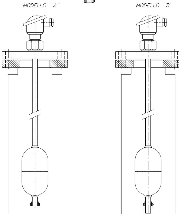
Lo schema a lato mostra un esempio di installazione. Lo strumento ha una zona "morta" sia all'inizio (L1) che alla fine (L2) delle corsa del galleggiante.
