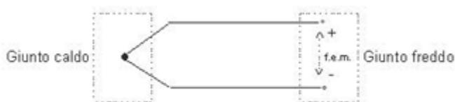
L'impiego delle termocoppie come elemento di misura di temperatura permette di ottenere misure precise ed affidabili nel campo compreso tra -200 e 1700 °C in relazione al tipo di termocoppia utilizzata.
